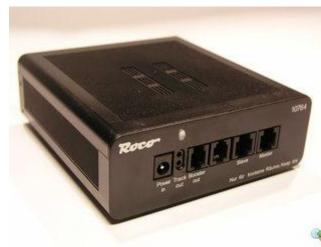
Reicht der Strom der beim Digitalbetrieb mit der ROCO Multimaus notwendigen Zentrale (10764 oder auch des älteren Modells 10761) nicht mehr aus, läßt sich eine Zentrale denkbar einfach in einen Booster umbauen. Da solche Zentralen durch die Startsets recht günstig in einschlägigen Auktionshäusern angeboten werden, ist der hier beschriebene Umbau ein einfaches und preiswertes Mittel, um einen Booster zu erhalten. Es können maximal 4 Booster an eine Zentrale
