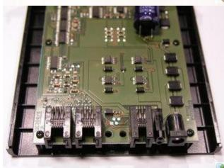
An der markierten, freien Stelle wird die neue Buchse eingelötet.
